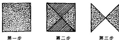
图 3 四分法取样步骤图
